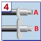
Положення насадки регулюється: «вушка» параллельно землі - рух зліва направо, «вушка» перпендикулярно землі - рух знизу вгору. Нанесення на стелю: робоче положення «вушка» - перпендикулярно землі, рух від себе на себе.
