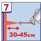
Напilenня виробляють на відстані від 30 до 45 см від поверхні в залежності від формування факела. Чим більша відстань – тим ширше поверхня напilenня.
