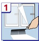
Робочі поверхні очистити від пилу, бруду, масляних плям і льоду. Зволожувати варто тільки пористі будівельні матеріали, такі як цегла, піноблоки, гіпс, бетон, дерево. Гладкі поверхні, такі як: метал, керамічна черепиця, скло і т. д. – не зволожуються. Оцинкований метал і профлист ретельно знежирити перед роботою. Рекомендують ся легке зволоження поверх напilenого Полінора.
