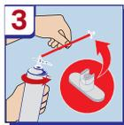
Накрутити ДО УПОРУ трубку-апликатор, оснащену насадкою для напilenня, на клапан балона (до моменту його вільного прокручування).
