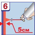
При напilenні курок натискати до упору. Товщина напilenного шару збільшується на 20% через 20 хвилин, тому напilenувати не більше 4 см (4 см + 20 хв = 5 см). При необхідності більшої товщини, наносити наступний шар через 20 хвилин після нанесення першого. Перед цим слід переконатися, що немає крапель води на попередньому шарі. Кількість шарів не обмежена.
