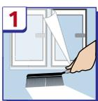
Рабочие поверхности очистить от пыли, грязи, масляных пятен и льда. Увлажнять стоит только пористые строительные материалы, такие как: кирпич, пеноблоки, гипс, бетон, дерево. Гладкие поверхности, такие как: металл, стекло и т.д.- не увлажняются. Оцинкованный металл и профлист тщательно обезжирить перед работой. Рекомендуется легкое увлажнение поверхности напыленного POLYNORa.
