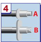
Положение насадки регулируется: «ушки» параллельно земле – движение слева направо, «ушки» перпендикулярно земле – движение снизу вверх. Нанесение на потолок: рабочее положение «ушки»-перпендикулярно земле, движение от себя на себя.
