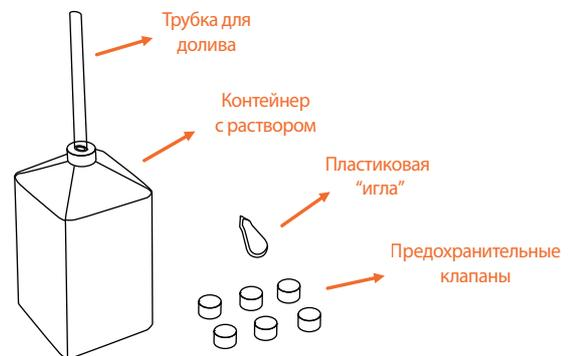
Шаг 4: Мягко залейте раствор во все ячейки в соотношении один контейнер на три ячейки. Избегайте перелива. Закройте предохранительный клапан крышкой, когда наполнение будет закончено.
