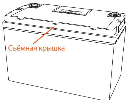
Шаг 2: Выньте 2 заполняющих контейнера и снимите 2 колпачка клапана.
