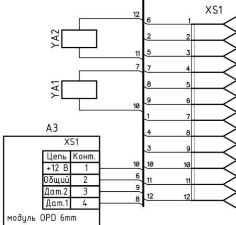
Схема электрическая принципиальная стойки роторных турникетов серии «Ростов-Дон Р2»
