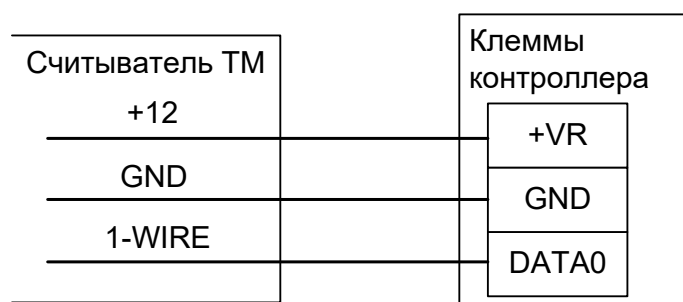
Рисунок 9. Пример подключения считывателя с выходным интерфейсом Touch memory.
