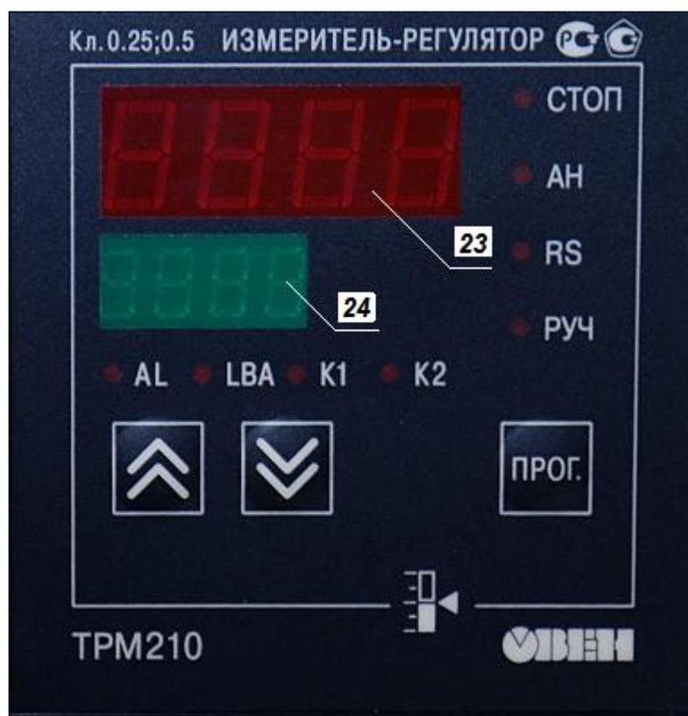
Рис.3. Лицевая панель измерителя-регулятора ТРМ210.
