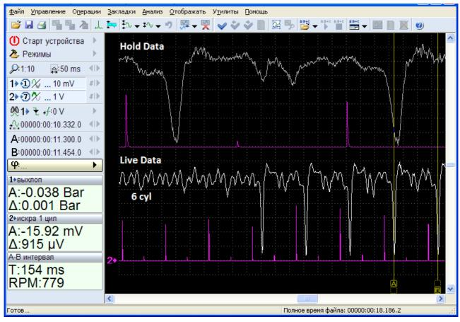
Если шланг в выхлопную трубу установить глубже, то амплитуда пульсаций от работающих цилиндров возрастает, тогда как амплитуда пульсаций возникающих вследствие пропусков воспламенения увеличивается незначительно. В результате, разница между пульсациями от работающих и неработающих цилиндров становится менее заметной.
