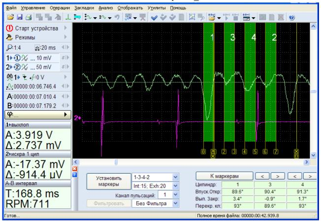
Несмотря на то, что эта панель предназначена для анализа пульсаций разряжения во впускном коллекторе, её можно использовать и для анализа неравномерности пульсаций на выхлопе. Чтобы порядок работы цилиндров соответствовал отображаемым на графике пульсациям, маркеры необходимо устанавливать не по меткам искры цилиндра 1, а посредине между этими метками.
