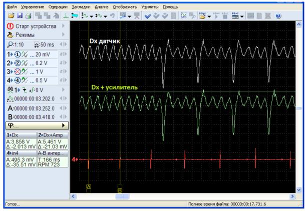
Порядок проведения измерений следующий. Чтобы настроить осциллограф для просмотра сигнала пульсаций выхлопа или записи сигнала для последующего просмотра, можно выбрать двух канальный режим. Развертку установить 5...10 ms на клетку, в зависимости от величины холостых оборотов двигателя и ширины экрана используемого монитора, так, чтобы на экране помещались две метки искры цилиндра 1. Для USB Autoscope III / IV в панели настройки канала 1 лучше выбрать максимальный предел напряжений ±6 V.
