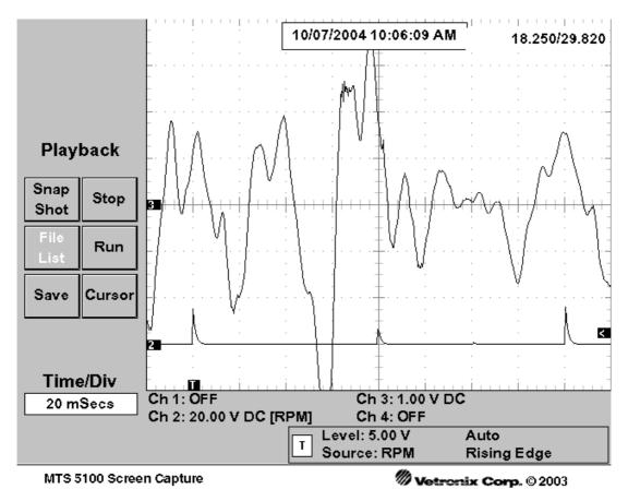
Но этот принцип не получил большого распространения из-за сложности получаемой формы сигнала. Ведь на фоне разных по величине дополнительных пульсаций, не так-то легко определить, в каком цилиндре имеется пропуск воспламенения, а в каком нет.
