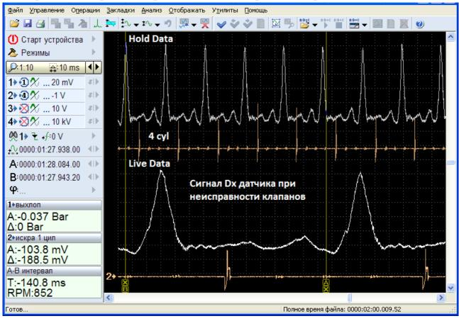
Правильную форму сигнала способны показывать датчики, отображающие фактическое давление, такие как датчик Dx. А датчики, основанные на пьезо-электрическом эффекте и показывающие только изменения давления, вносят некоторые искажения в реальную форму сигнала. В зависимости от подключения к выхлопной трубе, датчики Dx и пьезо-электрический, могут по разному отображать сигнал пульсаций выхлопа.
