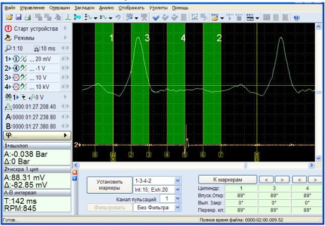
Следует заметить что номера цилиндров, показанные на приведенном выше графике пульсаций, не указывают на проблемный цилиндр, так как положительная полярность пульсаций на выхлопе указывает не на пропуск воспламенения, а на прорыв газов через выпускные клапана. Согласно порядку работы цилиндров, когда цилиндр 3 находится на такте выпуска отработавших газов, в цилиндре 4 происходит такт рабочего хода, когда газы могут прорываться в выпускную систему через неплотно закрытые выпускные клапана.
