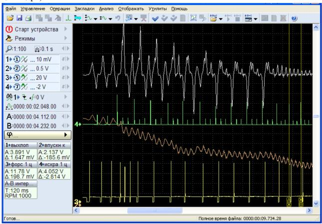
Основная проблема здесь — это пропуски воспламенения в цилиндрах 2 и 3 из-за износа свечей зажигания. Кратковременные отклонения в работе клапанов при запуске двигателя хоть и присутствовали, но на работу двигателя в штатных режимах они не влияли.
