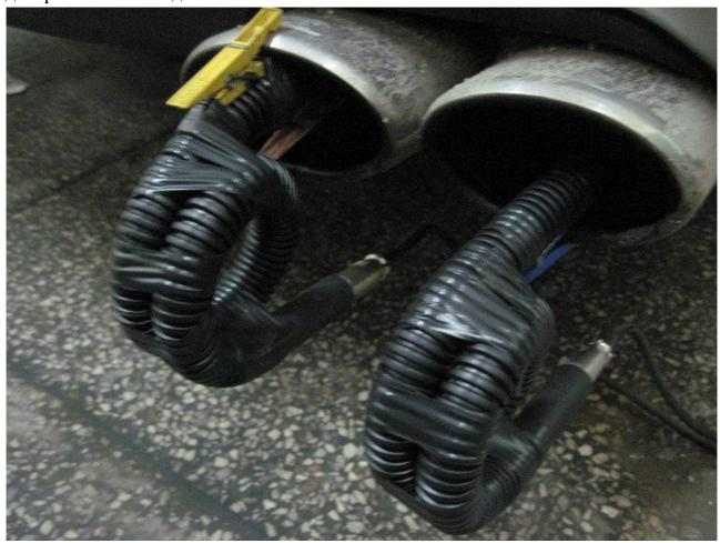
Глубина установки шлага в выхлопной трубе влияет на амплитуду и, частично, на форму получаемого сигнала. При правильно выбранной глубине, на горизонтальной линии сигнала будут заметны небольшие пульсации, а пропуск воспламенения будет выглядеть значительным провалом сигнала, что хорошо сочетается с логическим восприятием пропуска воспламенения.
