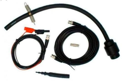
Для анализа пульсаций потока выхлопных газов, патрубок датчика FirstLook необходимо было вставить в выхлопную трубу и записать его выходной сигнал совместно с сигналом искры цилиндра 1.
