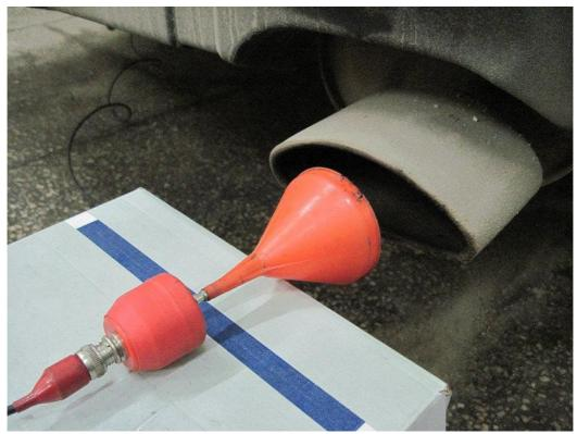
Различия в сигналах теперь получились хорошо заметными: на фоне почти ровной линии, отражающей нормальную работу цилиндров, пропуск воспламенения стал выглядеть как хорошо заметный всплеск. Но полярность импульса, отражающего пропуск воспламенения, получилась необычной.
