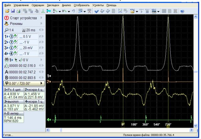
Здесь хорошо видно, что момент появления пропуска воспламенения на выхлопной трубе отстаёт от начала такта выпуска примерно на 180° угла поворота коленвала. При этом, задержка на прохождение импульса по выхлопной трубе составляет около 30 ms. Поэтому, данный метод больше подходит для определение пропусков воспламенения на холостых оборотах двигателя.
