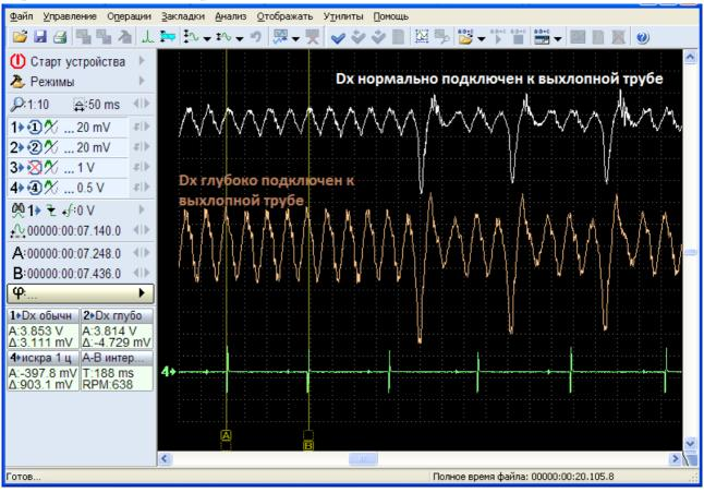
Но небольшие пульсации от работающих цилиндров полезны для визуального отсчёта номеров цилиндров относительно искры цилиндра 1.
