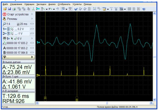
Это может оказаться неудобным при анализе некоторых неисправностей, к примеру, связанных с работой клапанного механизма. Если датчик будет показывать двойные импульсы, а в действительности присутствовать только одинарные, то определить различия в некоторых неисправностях будет сложно.
