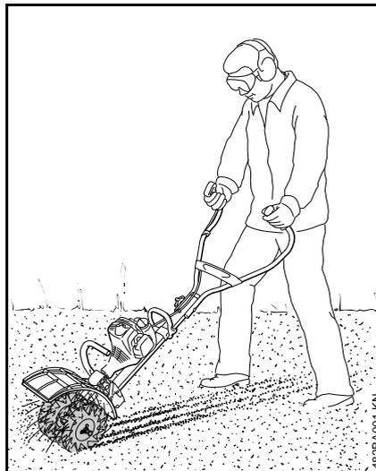
Мультиинструмент аэратор для газона RL-MM служит для аэрации поверхности газонов (надрезание травяного покрова).
