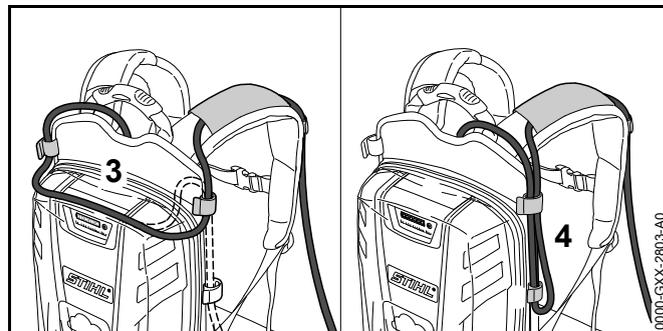
Длину соединительного кабеля можно регулировать петлей на наспинной пластине (3) или боковой петлей (4).
