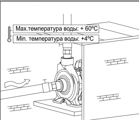
1. Для установки насоса входная труба должна быть настолько короткой насколько возможно с наименьшим количеством изгибов. Насос должен быть установлен в вентилируемом и сухом месте. Насос может быть установлен на улице с условием обеспечения надлежащего перекрытия для предотвращения негативного влияния погодных условий.
