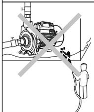
4. Избегайте разбрызгивания воды под давлением в электрический насос, а также не допускайте погружения (даже частичного) электронасоса в воду.
