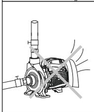
5. Насос должен находиться в вентилируемом помещении, конструкция которого должна предотвращать проникновение атмосферных осадков на корпус и внутрь электродвигателя.
