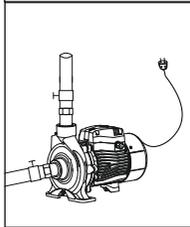
7. Перекачиваемая жидкость может быть горячей и под высоким давлением, прежде чем демонтировать насос, клапаны на обеих сторонах трубопровода должны быть перекрыты, чтобы избежать ожога.
