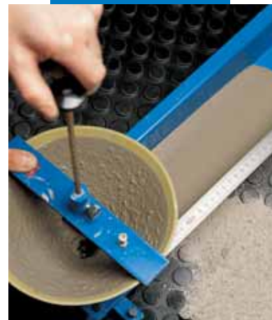
Испытание расширения в канавке согласно норме UNI 8997/89
