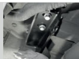
**ШАГ 5.** Затяните все резьбовые соединения. Установите шар в сборе. Зафиксируйте шар пальцем для фаркопа и проденьте в него шплинт. Затяните нижний винт крепления M10x20. Установка завершена.
