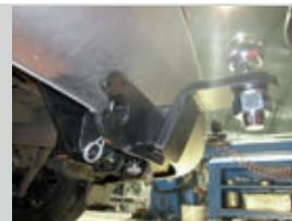
Тип шара «Е»; Тип соединения: шаровый; Диаметр сцепного шара: 50 мм.; Масса комплекта ТСУ 11041501: 23 кг.
