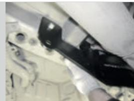
**ШАГ 3.** Установите центральный кронштейн, совместив отверстия в кронштейне центральном с отверстиями в боковых кронштейнах и соедините всё с помощью болтов M10x40x1,25, гаек M10x1,25, шайб на 10 и шайб пружинных на 10.
