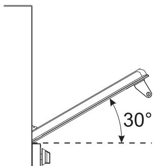
Для повторной установки вставить петли в специальные отверстия, имеющиеся в духовке, убедившись в том, что желобки **C** прислоняются полностью на отверстия. Опустить дверцу вниз и после ее установки вынуть стержни из отверстий петель.
