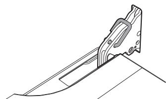
Взять дверцу за обе стороны двумя руками рядом с петлями, приподнять ее под углом приблизительно 30° и вынуть.
