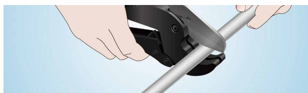
1. Отрежьте трубу под прямым углом
