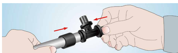
5. Вставьте штуцер фитинга в расширенную трубу
