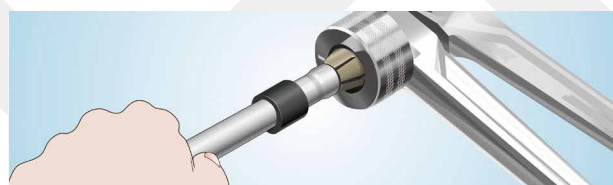
4. Расширьте конец трубы
