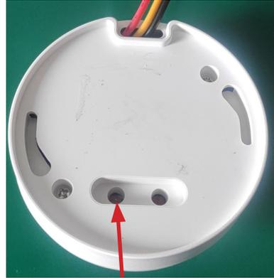
Винт регулировки времени
