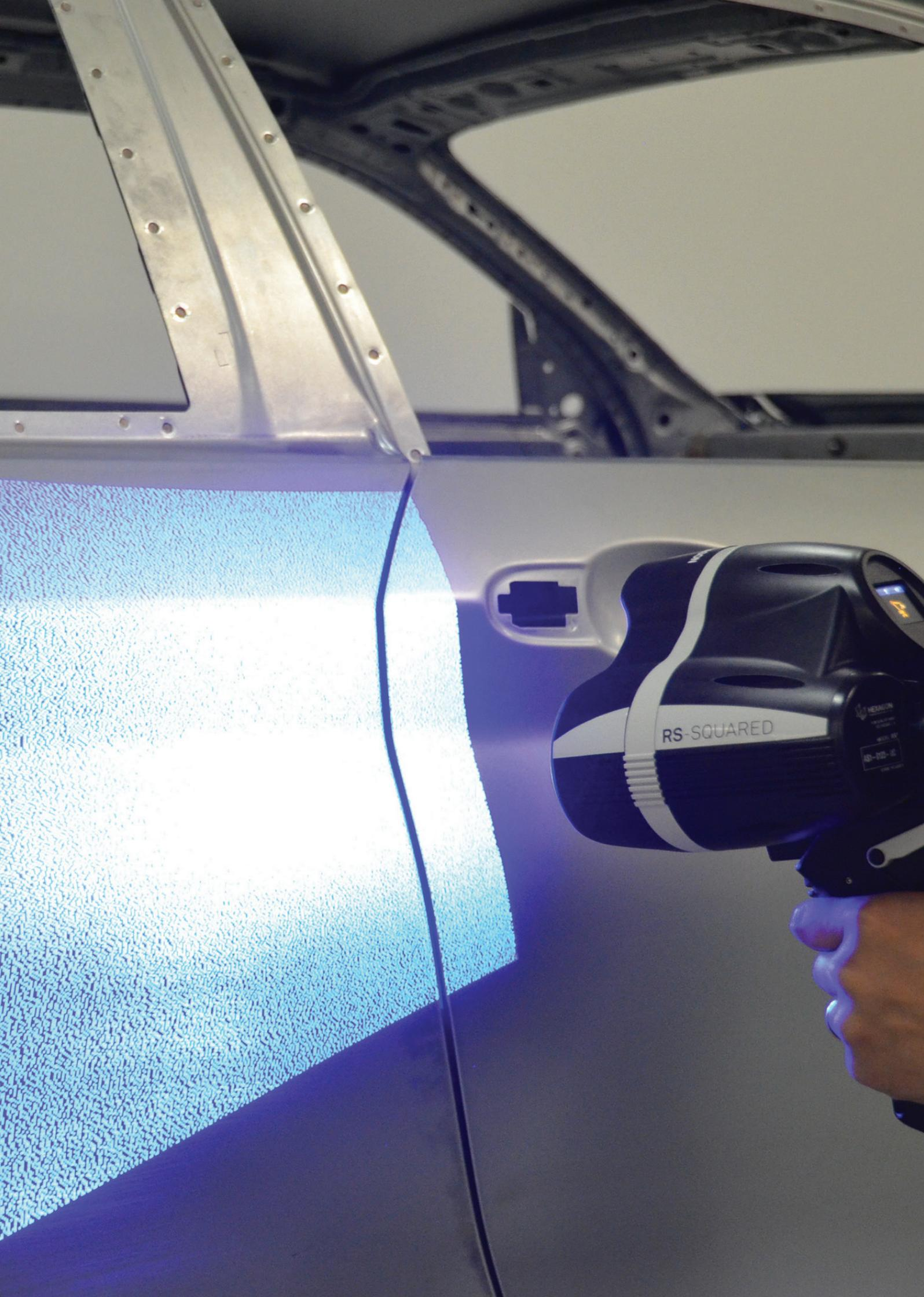
Часто время, необходимое для сканирования детали, является самым важным фактором при планировании измерительных задач. Часто деталь бывает доступна для измерения ограниченное время или может находиться в месте, неудобном для измерения. Поэтому Hexagon создал сканер площадной сканер RS-SQUARED первый в мире сканер структурированной подсветки, устанавливаемый на портативный измерительный манипулятор.
