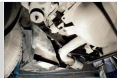
**ШАГ 3.** Установите центральный кронштейн, совместив отверстия в кронштейне центральном с отверстиями в боковых кронштейнах и соедините всё с помощью болтов M10x40x1,25, гаек M10x1,25, шайб M10 и шайб пружинных M10.
