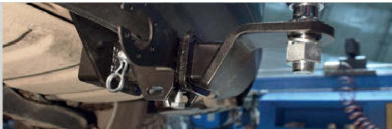
Тип шара «Е»; Тип соединения: шаровый; Диаметр сцепного шара: 50 мм.; Масса комплекта ТСУ 23011501: 17,7 кг.
