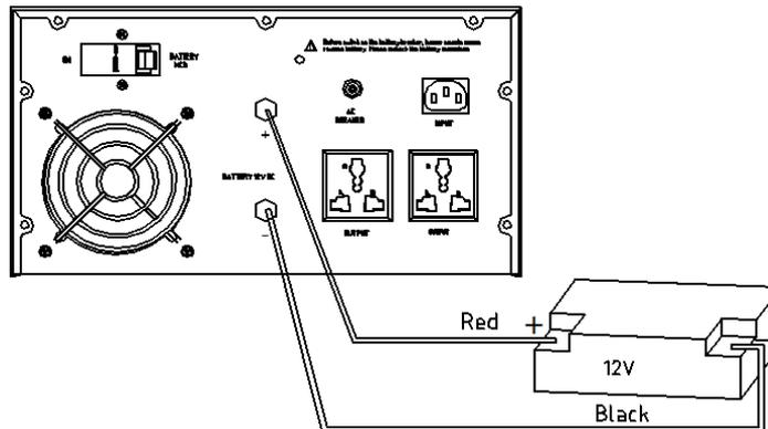
Схема подключения аккумуляторной батареи.
