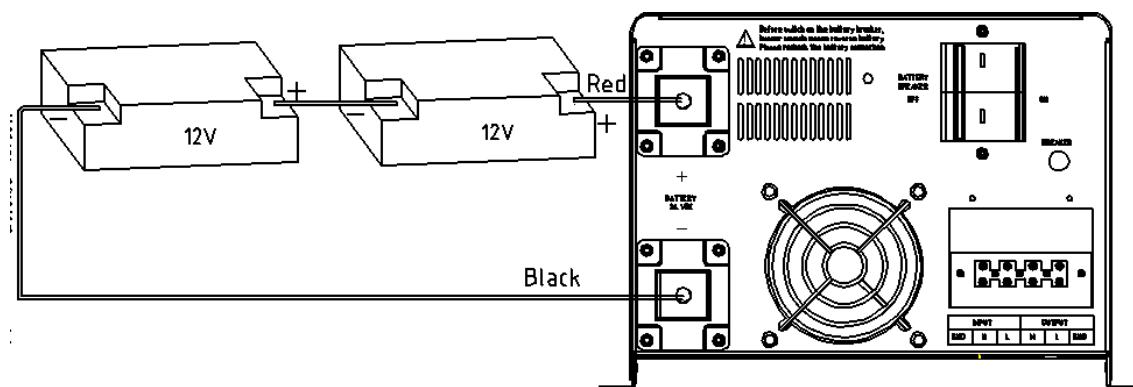
Схема подключения аккумуляторных батарей.
