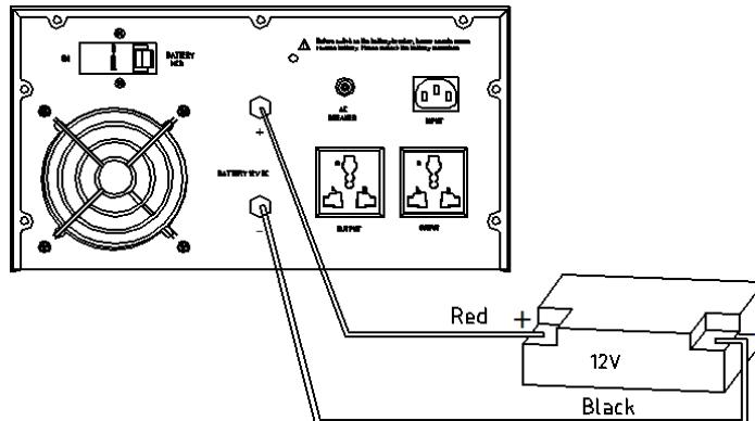
Схема подключения аккумуляторной батареи.
