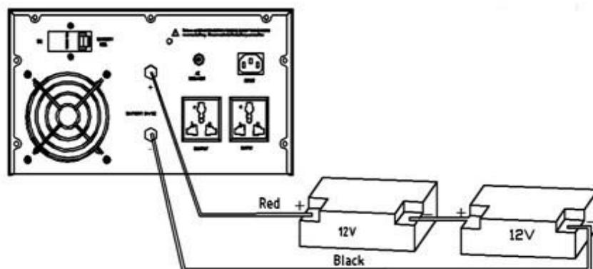
Схема подключения аккумуляторных батарей.
