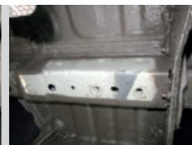
**ШАГ 2.** Установите кронштейн левый, совместив отверстия кронштейна с отверстиями в лонжероне автомобиля и соедините их с закладными пластинами с помощью болтов М10х40х1,25 через шайбы М10 и гроверные шайбы М10.
