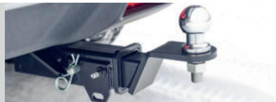
Тип шара «Е»; Тип соединения: шаровый; Диаметр сцепного шара: 50 мм.; Масса комплекта ТСУ 08101501: 17,9 кг.
