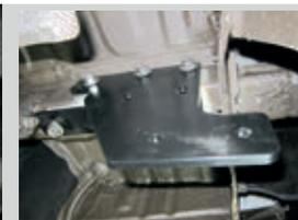
**ШАГ 4.** Установите кронштейн сварной, совместив отверстия в боковых кронштейнах с отв-ми балки и соедините их с помощью болтов М10х40 через шайбы и гроверные шайбы М10. Установите кронштейн крепления розетки, шар в сборе и зафиксируйте его шплинтом.
