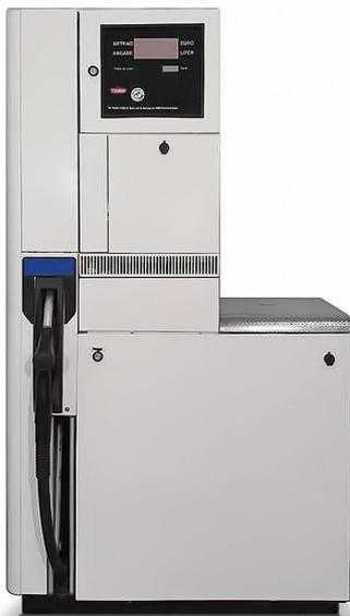
Топливораздаточная колонка Tokheim Quantum 510 1x2 всасывающего типа на один сорт топлива. Система возврата шлангов. Оснащена: электроникой WWC с защитой паролем, двусторонней ЖК индикацией с подсветкой. Расходомеры: TQM Насосы: ERZ-90
