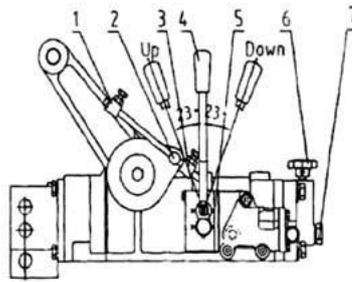
Рис.2. Гидравлический подъемник.
