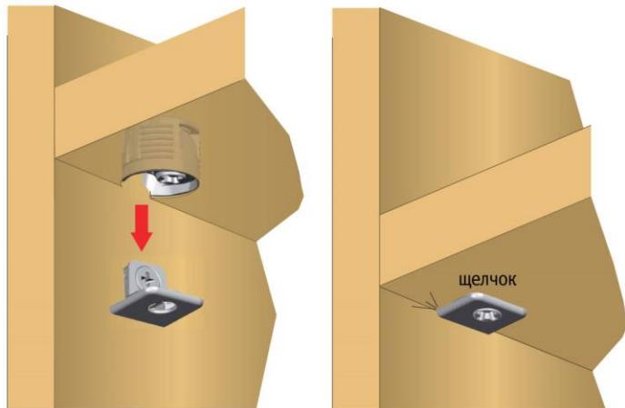
Установите полку со вставленными корпусами на опоры полкодержателя.
