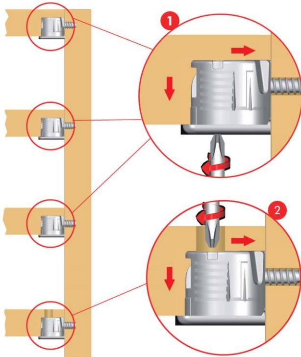
**1** Стягивание полок и верхней части конструкции осуществляется снизу поворотом отвертки на 90°.
