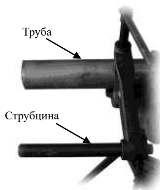
Струбцина, установленная на трубе
