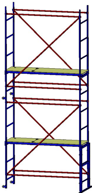
Двое подмостей могут соединяться в двухъярусные подмости высотой 3,6м, имеющий две площадки,
