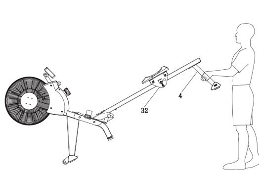
Для транспортировки тренажера поднимите заднюю опорную трубу пока не коснетесь земли колесиком на передней опорной трубе.
