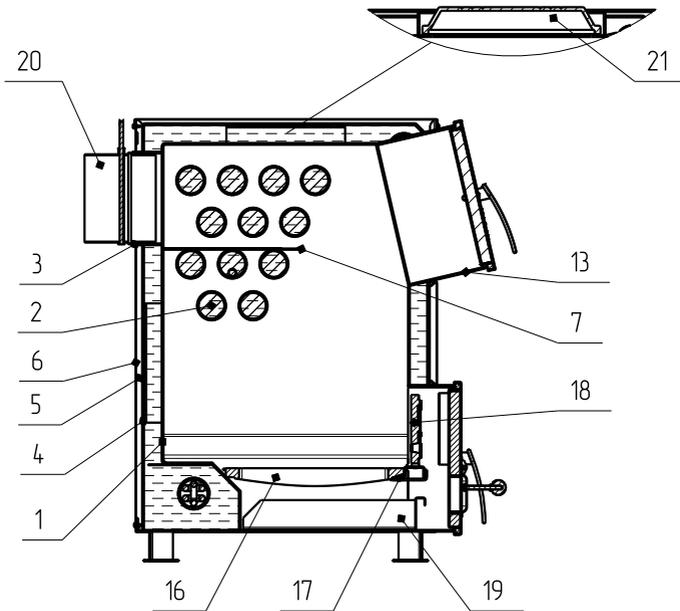
Рис.1. Конструкция котлов модельного ряда "Куппер"
