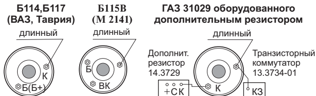
Рис. 2 - Подключение к карбюраторному двигателю
