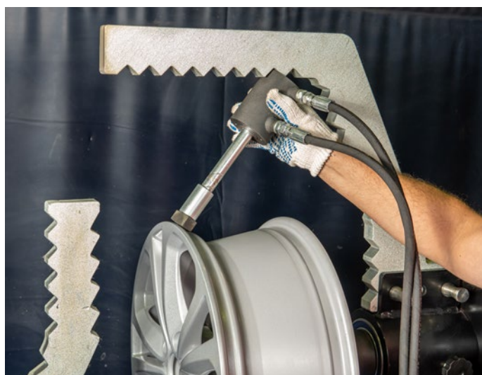
При повреждении от внутренней к наружной стороне обода
