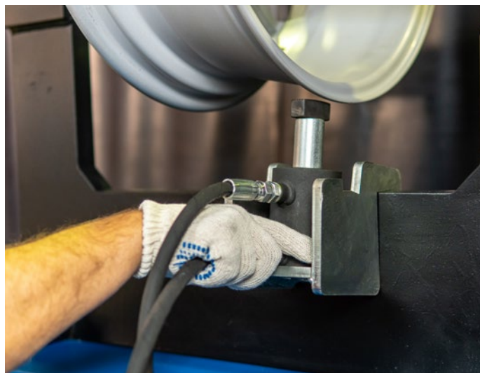
При повреждении от внутренней к наружной стороне обода
