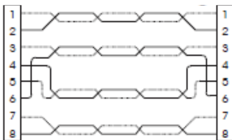
Тест пройден, неэкранированная витая пара
