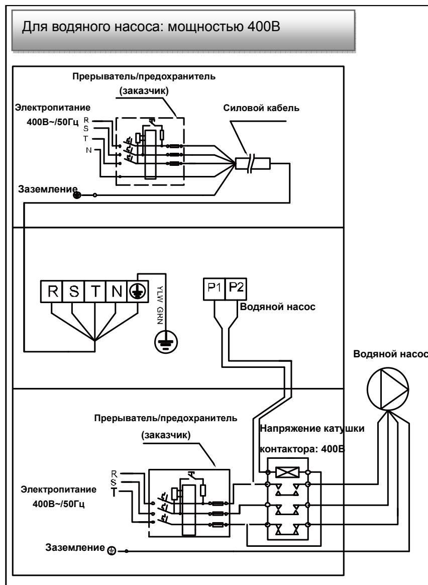
Параллельное соединение с таймером фильтрации
