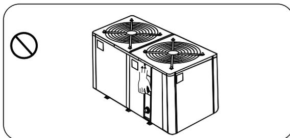
1.4.4. Не вставляйте посторонние предметы в отверстия для входа/выхода воздуха теплового насоса. Это приведет к снижению производительности насоса или к его остановке.
