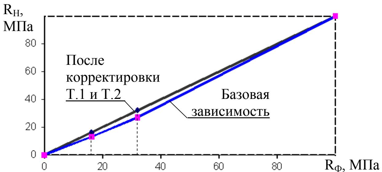
Измеритель позволяет произвести корректировку базовой зависимости при количестве точек корректировки от 1 до 9 в диапазоне 5...80 МПа.
