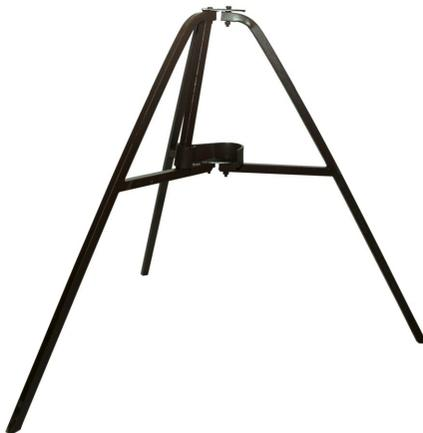
Данный элемент опалубочной системы предназначен для жесткой фиксации стойки в вертикальном положении. У треноги имеются три опоры, две из них не оборудованы жесткими фиксаторами. Это сделано специально для того, чтобы телескопическая стойка могла быть укреплена непосредственно у стены или в углах. Отсутствие жесткой фиксации обеспечивает компактность треноги, удобство ее транспортировки и хранения.
