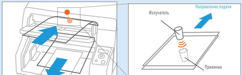
Датчик обнаруживает двойную подачу, и сканер немедленно прекращает процесс сканирования.
