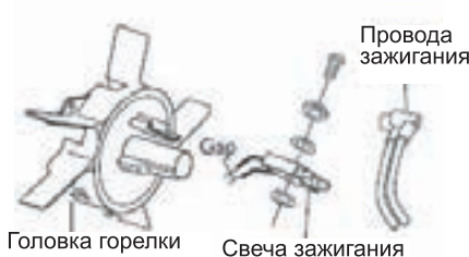
Рис. 18 Установка свечи зажигания
