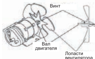
Рис. 16 – Обслуживание вентилятора (для всех моделей, за исключением TK-100000)
