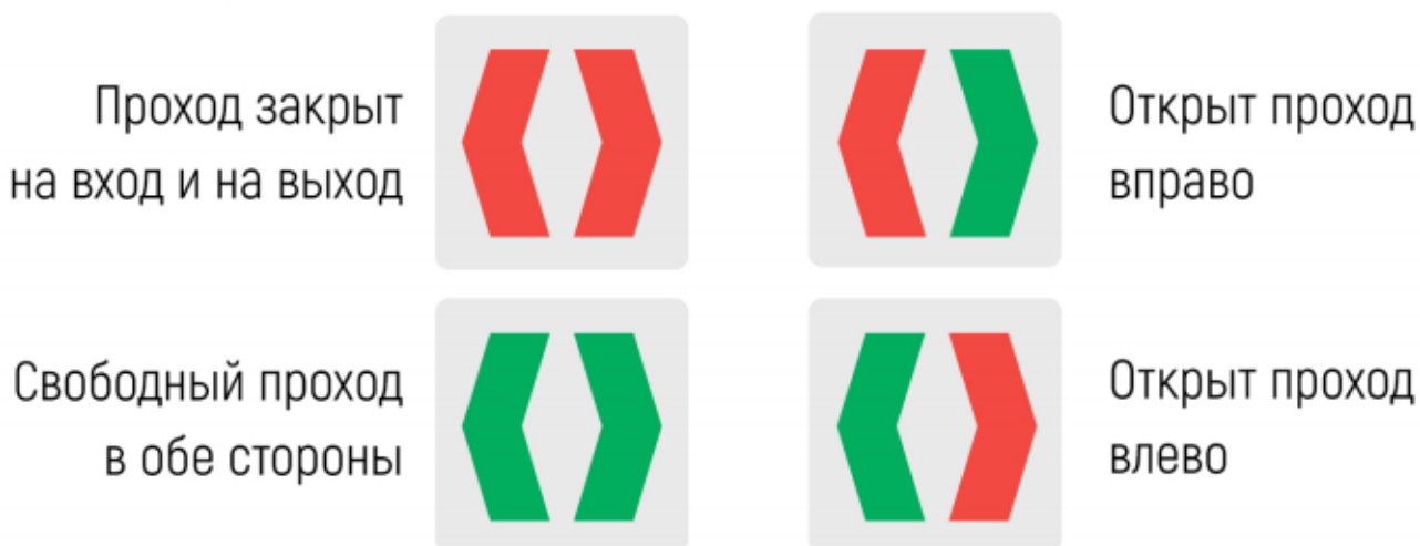
Рисунок 8 – Режимы индикации турникета
