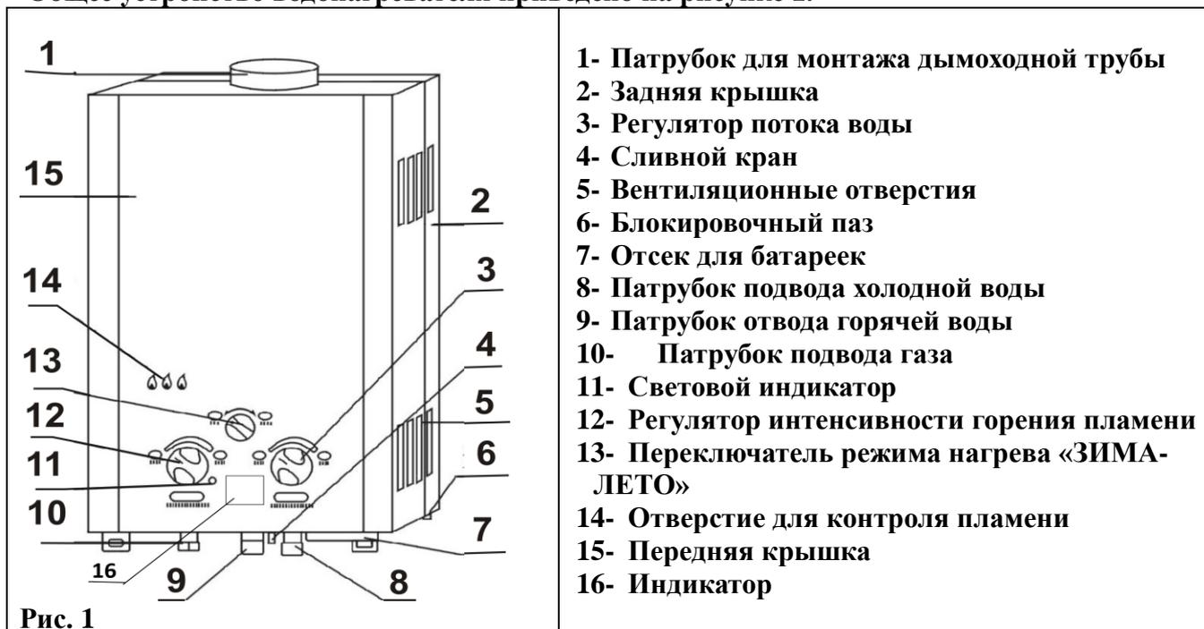
Обратите внимание на цвет патрубков: патрубок подвода газа — серый, а патрубки подвода холодной воды и отвода горячей воды — желтые!
