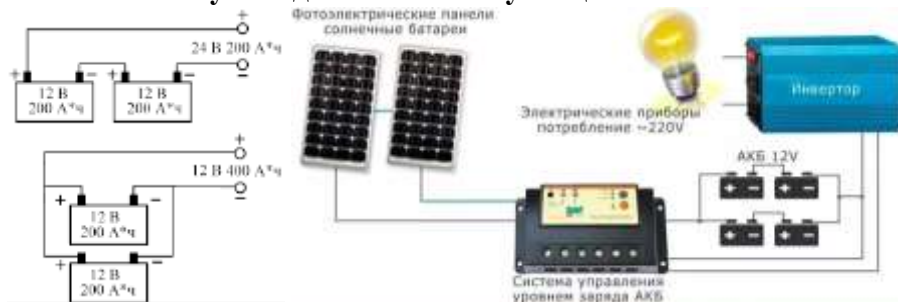
Рисунок 2 Схема подключения АКБ 12/24В и инверторов серии ТВЕ
