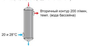
Примеры изменения эффективности теплообменника в зависимости от температуры теплоносителя 60, 70, 80, 90°С.
