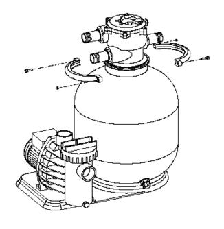
9 – Замочите в горячей воде конец шланга (42 см) для размягчения, затем наденьте шланг на впускное соединение. Правильно затяните хомут гаечным ключом № 7 (не допускается применение отвертки, т. к. возможно повреждение шланга). Повторите операцию на другом конце шланга (не забудьте о гайке). При установке соединения насоса не забудьте об уплотнительных кольцах.
