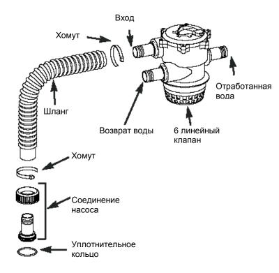
**10** – Подключите к бассейну соединения входа и возврата воды системы фильтрации (рисунок 10).
