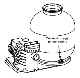
**4** - Установите в колбе фильтра коллекторную трубку. Закройте верх трубки тефлоновой лентой (рисунок 4).
