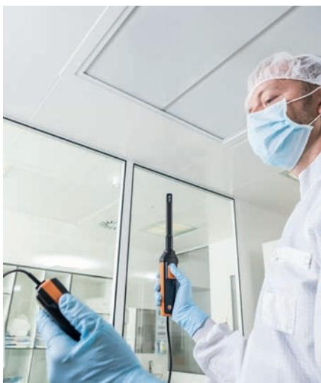
Вам нужно провести измерения там, где использование Bluetooth невозможно? Нет проблем: просто подключите зонд-наконечник к рукоятке с кабелем вместо рукоятки с Bluetooth, и вы готовы к работе
