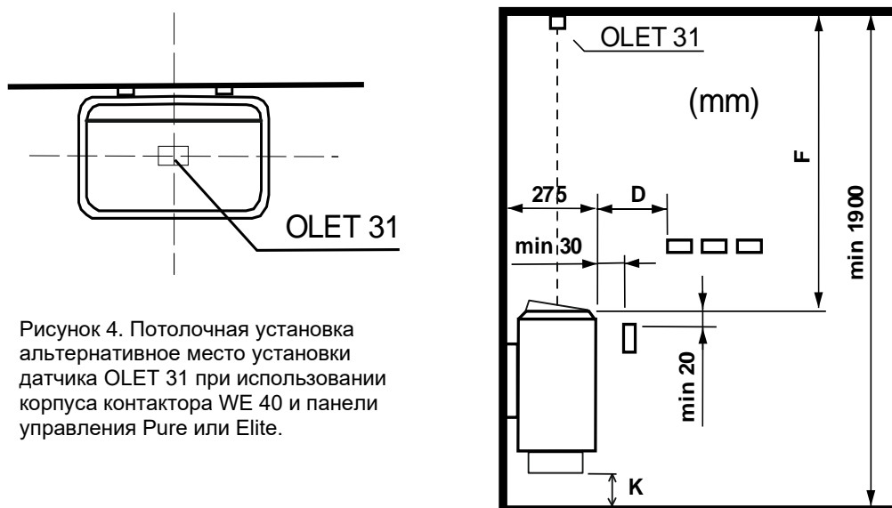
Рисунок 3 Безопасные расстояния и положение датчика
