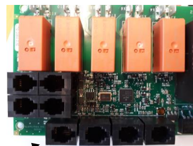
Illustration 4 . Ordre des connecteurs RJ 10. Capteur, interrupteur de porte, télécommande, capteur NTC supplémentaire.
