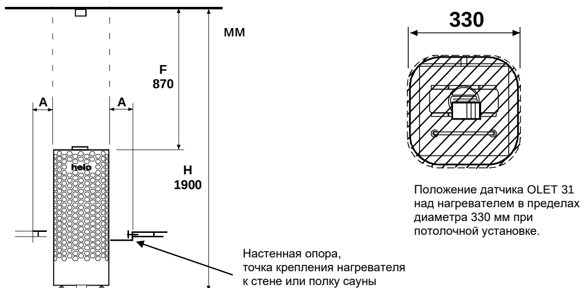
Рис 2 Безопасные расстояния электрокаменки
