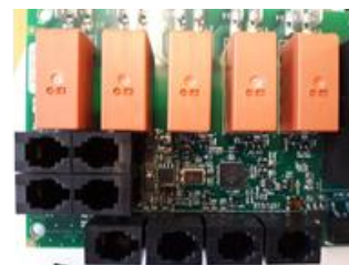
Рис 4 Расположение разъемов RJ 10. Датчик, дверной выключатель, дистанционное управление, дополнительный датчик NTC
