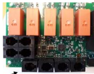
Imagen 4 Orden de los conectores RJ 10. Sensor, interruptor de puerta, control remoto, NTC adicional
