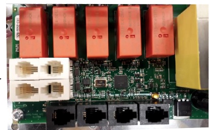
Abbildung 5 Reihenfolge der RJ 10-Anschlüsse. Sensor, Türschalter, Fernbedienung, zusätzlicher NTC
