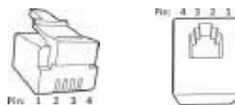
Kuva 8 RJ10 liittimien Pin -järjestys
