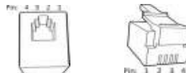
Obrázek 8 Rozvržení pinů konektoru RJ10
