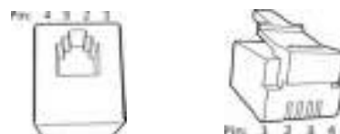
Imagen 8 Disposición de clavijas de un conector RJ10
