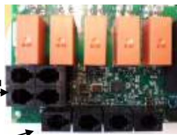
Rysunek 6 . Kolejność złączy RJ 10. Czujnik, przełącznik drzwiowy, sterowanie zdalne, dodatkowe NTC
