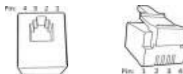
Rysunek 8 Układ styków złącza RJ10
