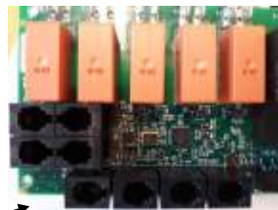
Joonis 6 . RJ 10 -konnektorite järjestus. Sensor, ukسلüliti, kaugjuhtimisseade, täiendav NTC
