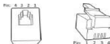
Imagen 8 Disposición de clavijas de un conector RJ10
