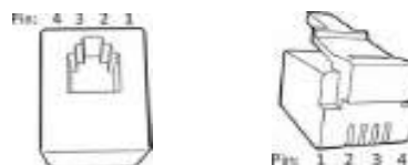
Rysunek 8 Układ styków złącza RJ10
