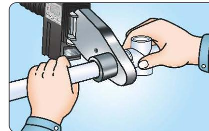
6. Вставьте трубу и фитинг в соответствующие нагревательные насадки. Выполните процесс сварки согласно *Таблицы Глубина прогрева трубы и длительность сварочных операций*, которая находится внутри каждого ящика сварочного аппарата марки Fusitek®
