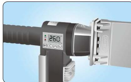
5. Нагрейте сварочный аппарат до 260°C, отмерьте глубину плавления на трубе согласно диаметра свариваемой трубы
