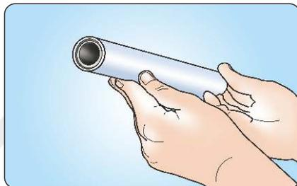
4. Проверьте качество торцевания трубы, убедитесь, что слой алюминия снят
