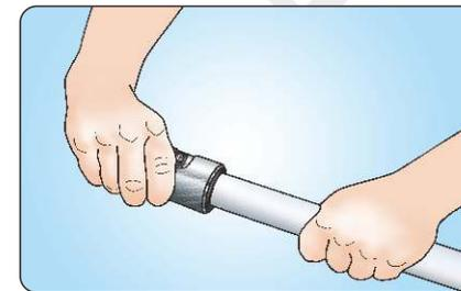
3. Вставьте трубу до упора в торцеватель и проверните торцеватель несколько раз вокруг трубы
