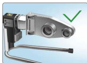
Правильное крепление нагревательных насадок
