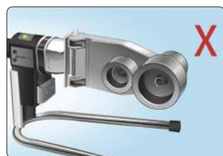
Неправильное крепление нагревательных насадок
