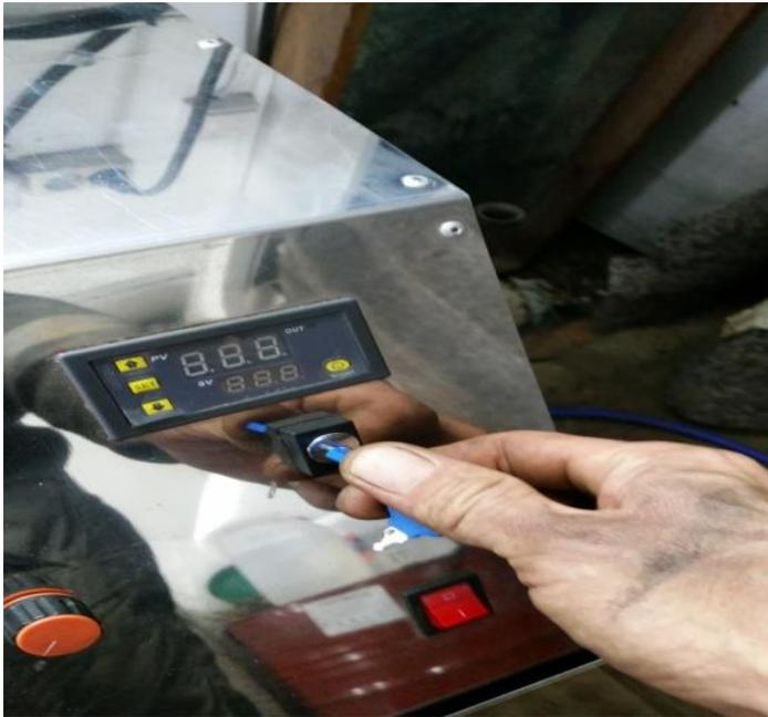
2) Повернуть регулятор мощности станции на MIN.
