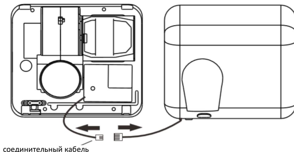
3. Установите устройство на стену с помощью самонарезных винтов, идущих в комплекте (при установке со скрытой проводкой подключите устройство к сети через отверстие для скрытой проводки в соответствии с рисунком 2)
